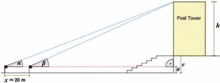
**B2** 👤 Bildet Dreiergruppen und geht vom Ausgangspunkt zwanzig Meter entlang des Weges in Richtung des Post Towers. Stellt an diesem Punkt euer geometrisches Quadrat erneut auf und bestimmt den Höhenwinkel  $\beta$ .
